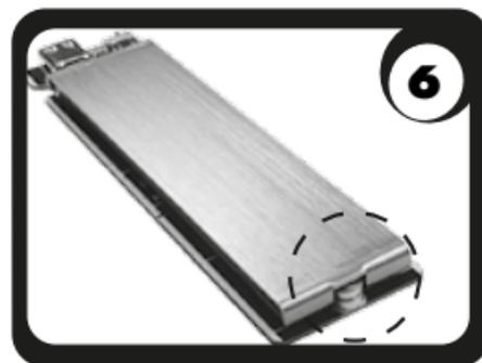
6. Setzen Sie den mitgelieferten Kühlkörper auf das Wärmeleitpad und richten Sie dessen Kerbe auf die M.2 Halterung aus.
