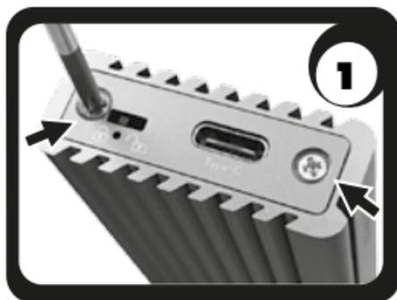
1. Entfernen Sie die zwei Schrauben A und öffnen Sie die vordere Abdeckung.
