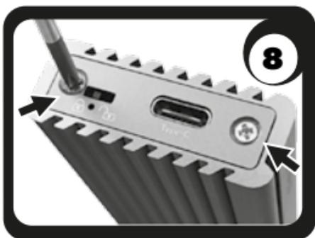
8. Befestigen Sie wieder die vordere Abdeckung. Stellen Sie sicher, dass der Schreibschutzschalter in der entsprechenden Aussparung der Abdeckung platziert ist.
